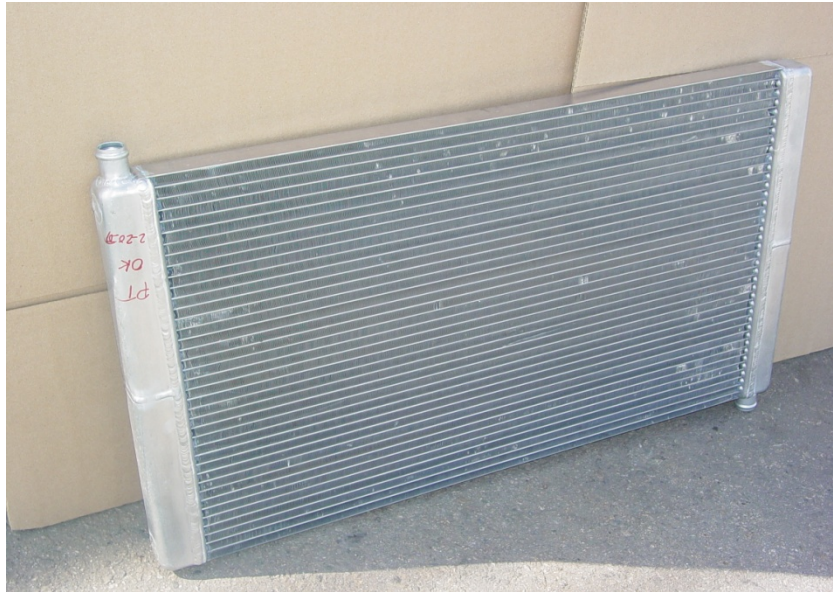
40 fins/in. Microchannel Fins
