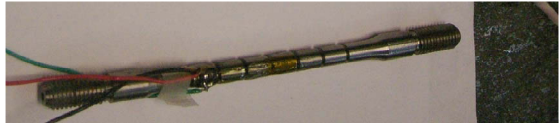
Miniature notch tensile specimen
