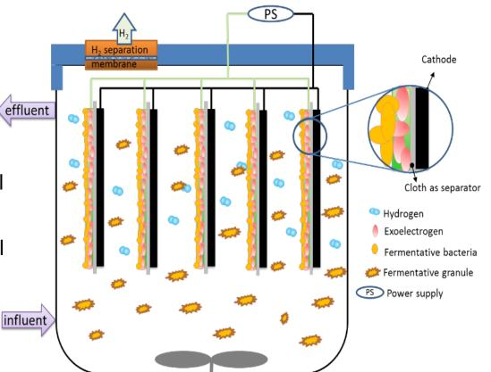
**Fermentation:**  $C_6H_{12}O_6 + 2H_2O \rightarrow 4H_2 + 2CO_2 + 2C_2H_4O_2$  **MEC Anode:**  $2C_2H_4O_2 + 4H_2O \rightarrow 4CO_2 + 16e^- + 16H^+$ **MEC Cathode:**  $16H^+ + 16e^- \rightarrow 8H_2$
