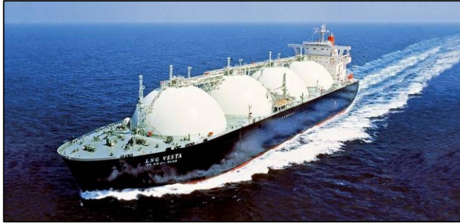
Largest Moss Type (Spherical Storage) LNG Carrier: 182,000 m 3
