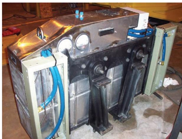
**FIGURE 5.** Metal-Hydride Storage Module
