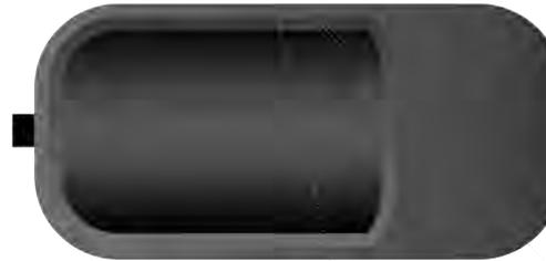
COMPOSITE OVERWRAPPED PRESSURE VESSEL
